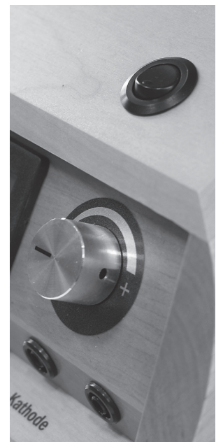
Das DFM-300 SAMi verfügt über eine integrierte Sprachausgabefunktion, die sich über einen Kippschalter zuschalten läßt.
